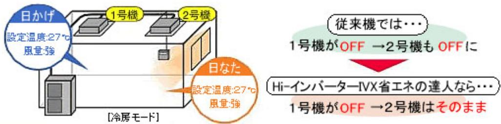
リモコン1台で、設定温度に達した負荷の少ない日かげの室内ユニットが止まっても、負荷の多い日なたの室内ユニットは引き続き稼働。室内負荷に応じた運転が可能です。
