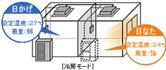
2台の室内ユニットを個別に運転する場合でも室外ユニットは1台で対応ができ、配管・配線工事の削減が可能。
